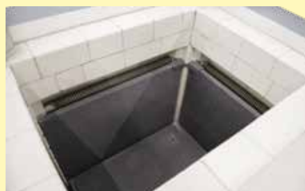
Revestimiento de los laterales y del suelo con placas de carburo de silicio como protección en el horno de cuba S 73/HS
