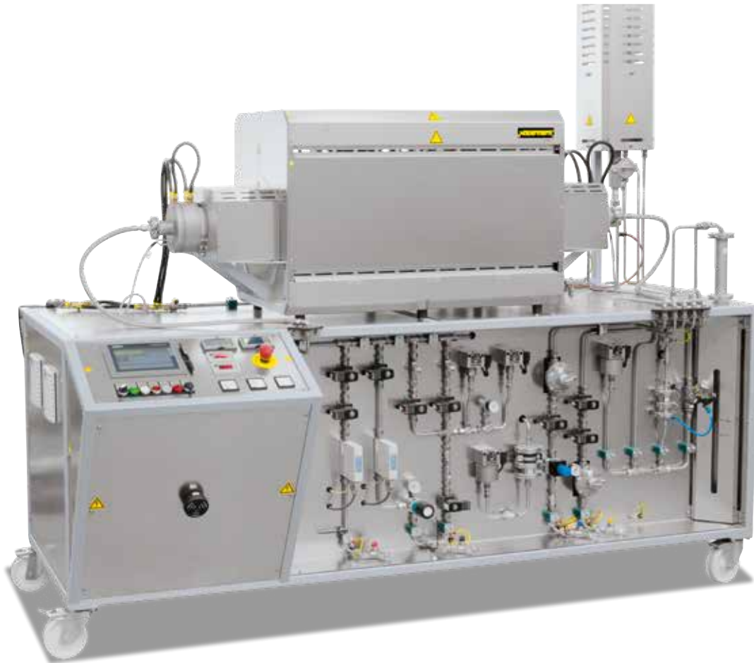
RHTH 120/600/18 con sistema de alimentación de gas 4 para el funcionamiento con hidrógeno
