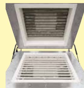
Calentamiento de la solera y la tapa, regulable de manera independiente
