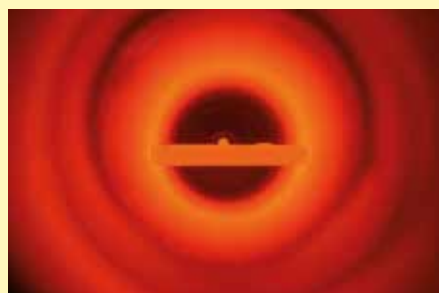
Sinterizado bajo hidrógeno en un horno tubular de la serie RHTH
