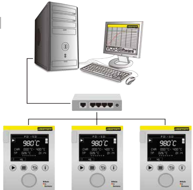
Ejemplo de instalación con 3 hornos
