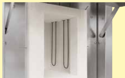
Elementos calefactores de alta calidad de disilicuro de molibdeno
