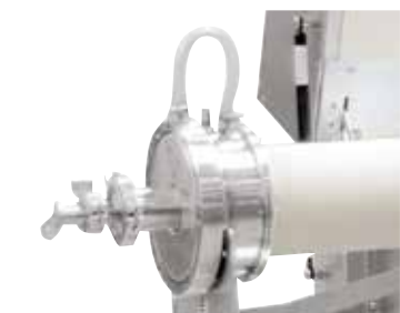
Brida de vacío refrigerada por agua (sistema de alimentación de gas 2)
