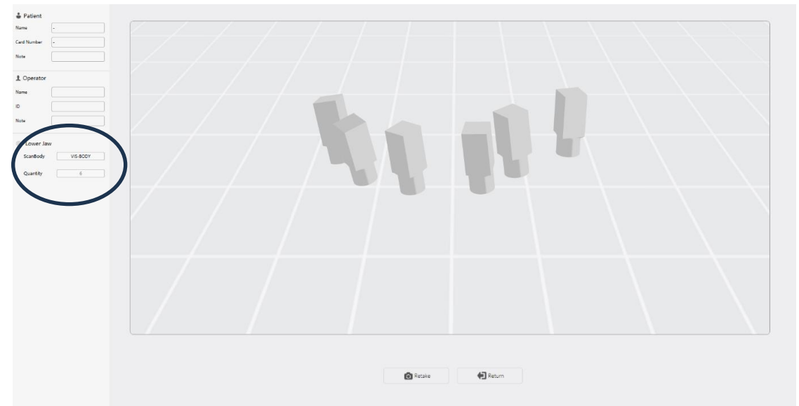
Selecciona el tipo y la cantidad de scanbodies antes de comenzar el escaneo
